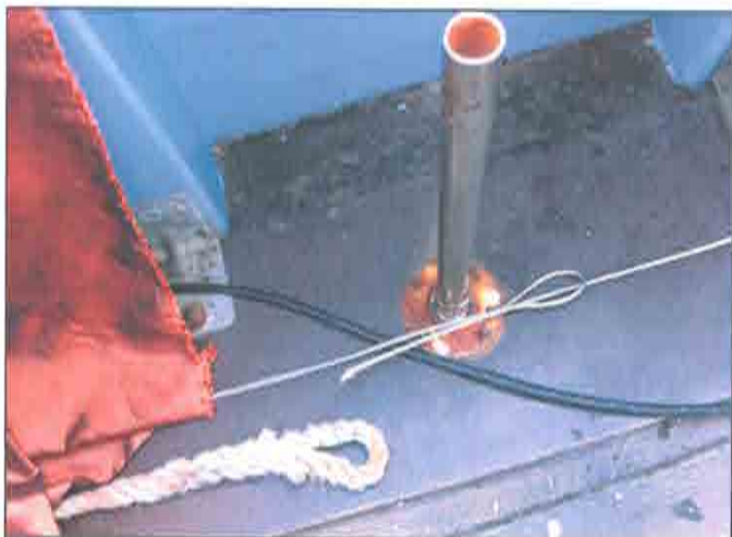
En stålwire er klippet over, formentlig med en boltsaks.
